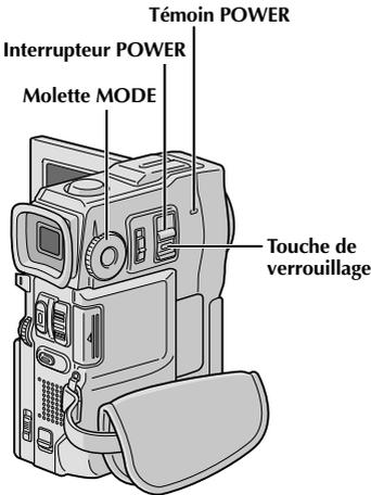
**1** Régler l'interrupteur **POWER** sur "**CAMERA**" tout en appuyant sur la touche de verrouillage située sur l'interrupteur et régler la molette **MODE** sur "**DSC**", puis ouvrir complètement l'écran LCD. Le témoin **POWER** s'allume et le caméscope est mis en marche.
