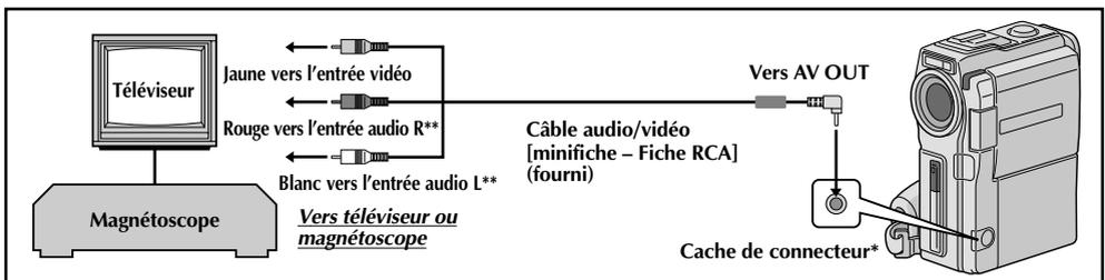
\* Pour raccorder le câble, ouvrir ce cache.
