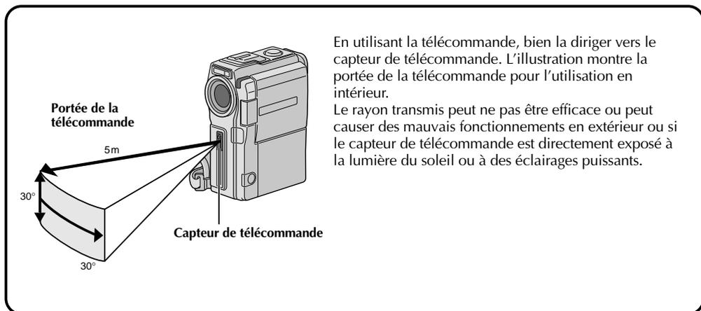
En utilisant la télécommande, bien la diriger vers le capteur de télécommande. L'illustration montre la portée de la télécommande pour l'utilisation en intérieur.
