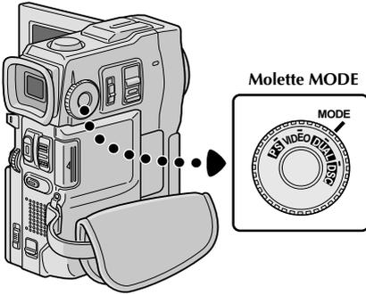
Les indications suivantes apparaissent dans le coin supérieur gauche, en fonction de la position de la molette **MODE**.
