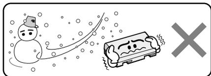
Les batteries lithium-ion sont vulnérables au froid.
