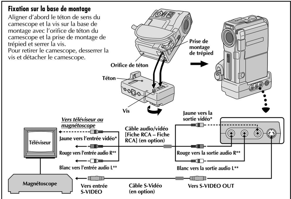
\* Raccorder quand un câble S-Vidéo n'est pas utilisé.
